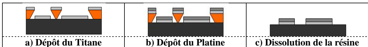
Figure 58 : Etapes de la pulvérisation cathodique
