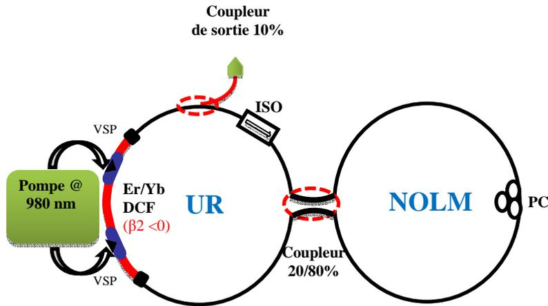
Figure 1: Dispositif expérimental.
