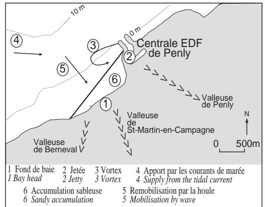
Figure 9 : Origine de l'accumulation de sable contre la jetée ouest de la Centrale EDF de Penly
