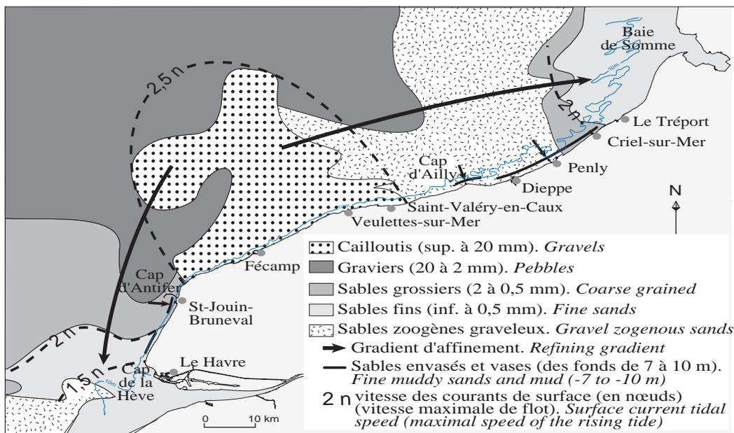
Figure 2 : Relation entre la répartition des sédiments superficiels et la vitesse des courants de marée (Costa, 1997, d'après Larssonneur et al., 1978)
